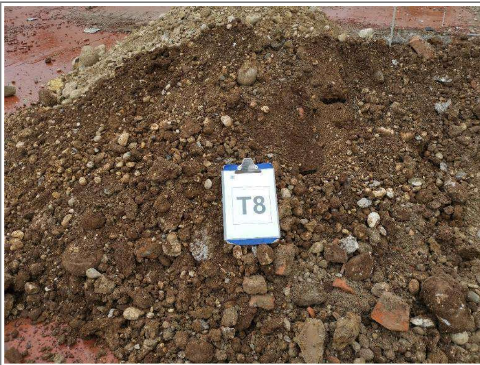
CUMULO DI MATERIALE ESCAVATO RIFERIBILE ALL'UNITÀ "R2"
