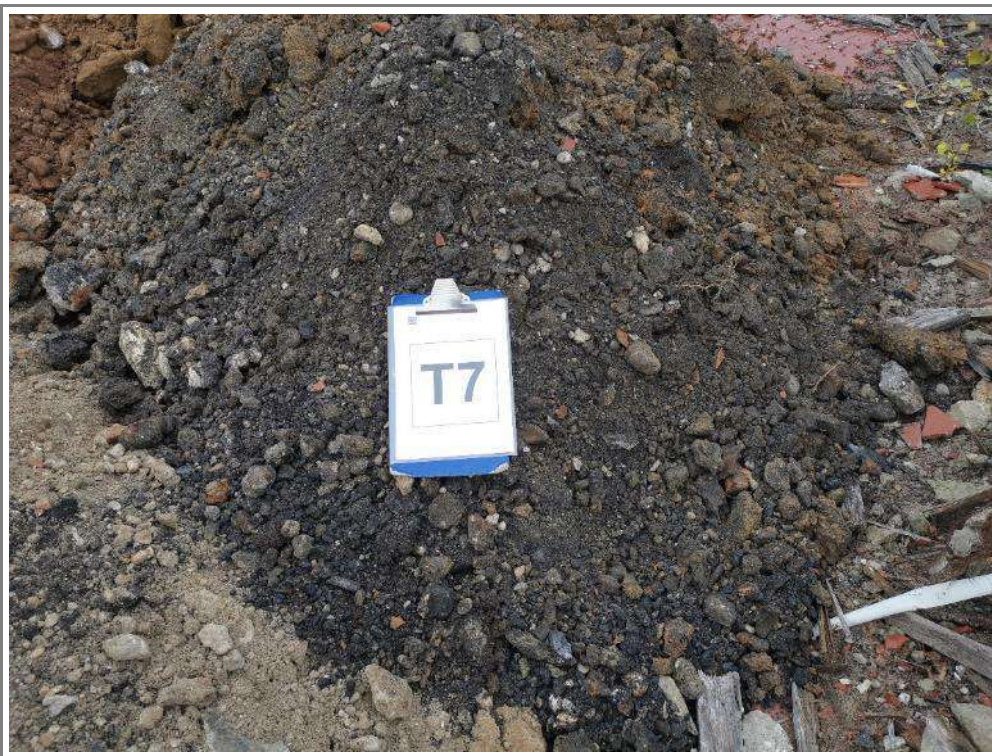
CUMULO DI MATERIALE ESCAVATO RIFERIBILE ALL'UNITÀ "Ra"
