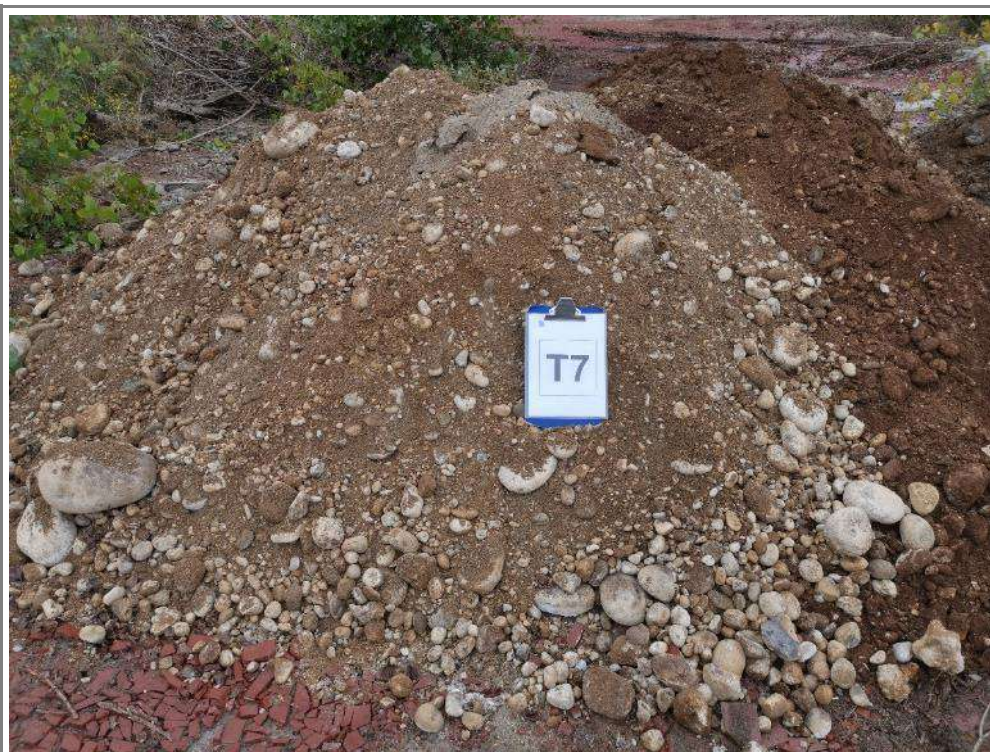
CUMULO DI MATERIALE ESCAVATO RIFERIBILE ALL'UNITÀ "G"
