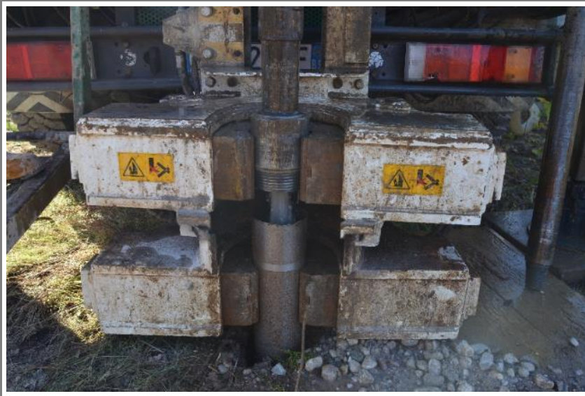
Fig. 38. Particolare della fase di esecuzione della prova "PP1" di permeabilità in foro di sondaggio con prova di abbassamento.
