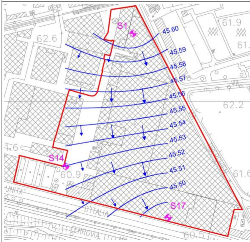
Fig. 17. Estratto da "Allegato 5 – Planimetria di sintesi dei risultati: acque sotterranee" relativa alla modellazione idrogeologica proposta nell'ambito dell'"Indagine ambientale preliminare".
