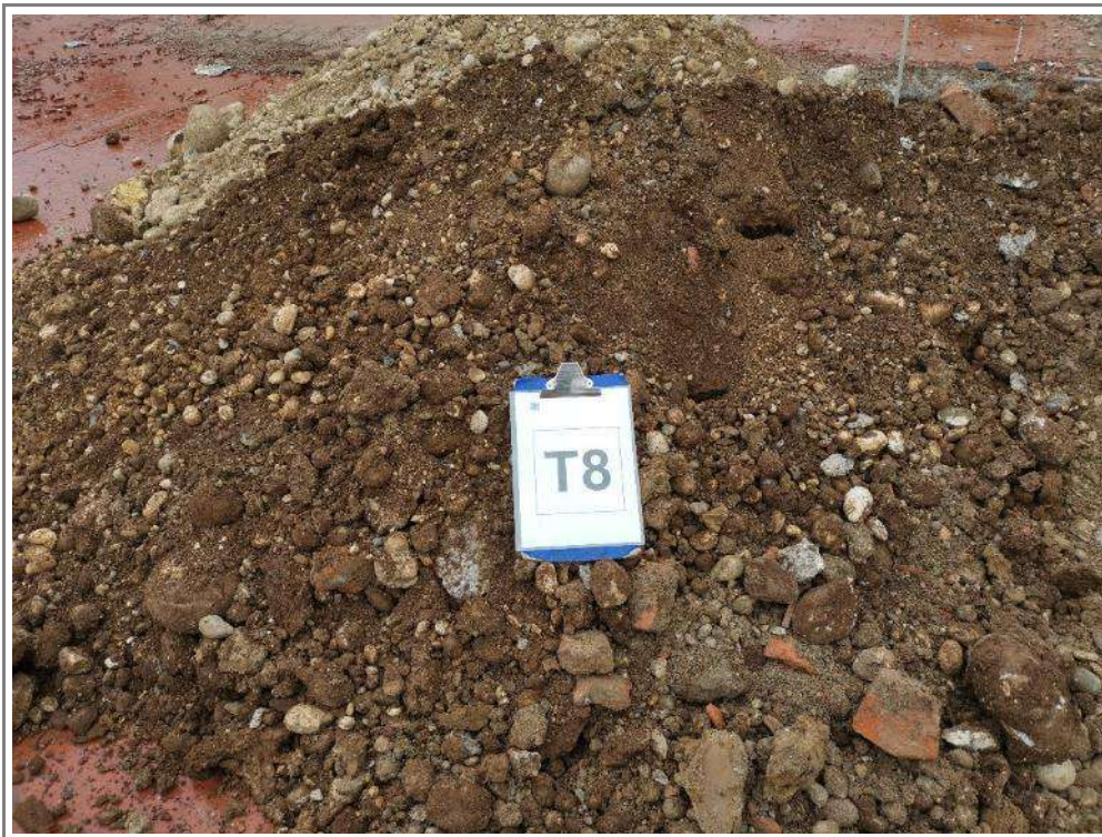
CUMULO DI MATERIALE ESCAVATO RIFERIBILE ALL'UNITÀ "R2"
