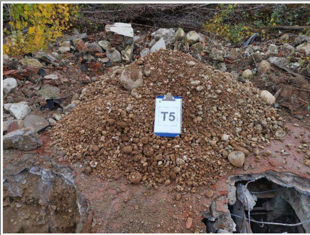
CUMULO DI MATERIALE ESCAVATO RIFERIBILE ALL'UNITÀ "G"
