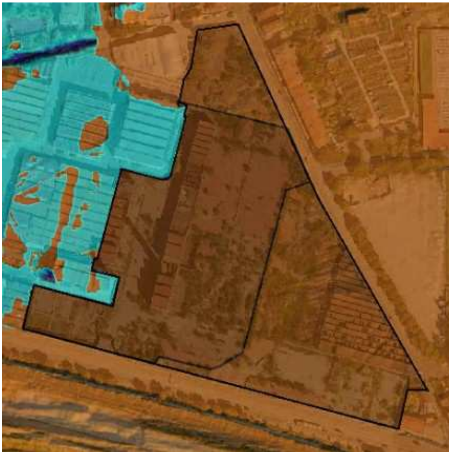
Figura 39: Planimetria dei risultati della modellazione in hec-ras con gli elementi utilizzati nello stato di progetto e sovrapposizione dell'ortofoto.
