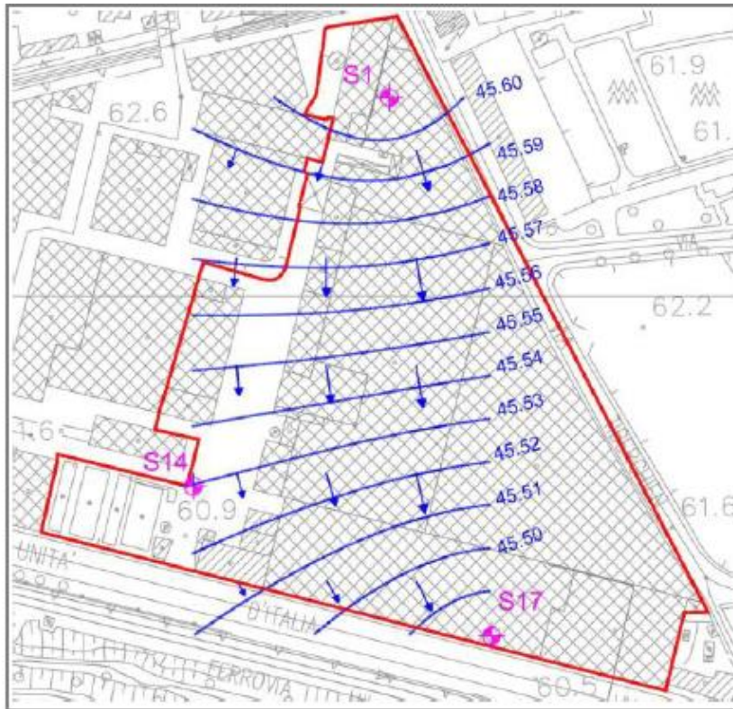
Immagine 11 – Estratto da “Allegato 5 – Planimetria di sintesi dei risultati: acque sotterranee” relativa alla modellazione idrogeologica proposta nell’ambito dell’“Indagine ambientale preliminare”.
