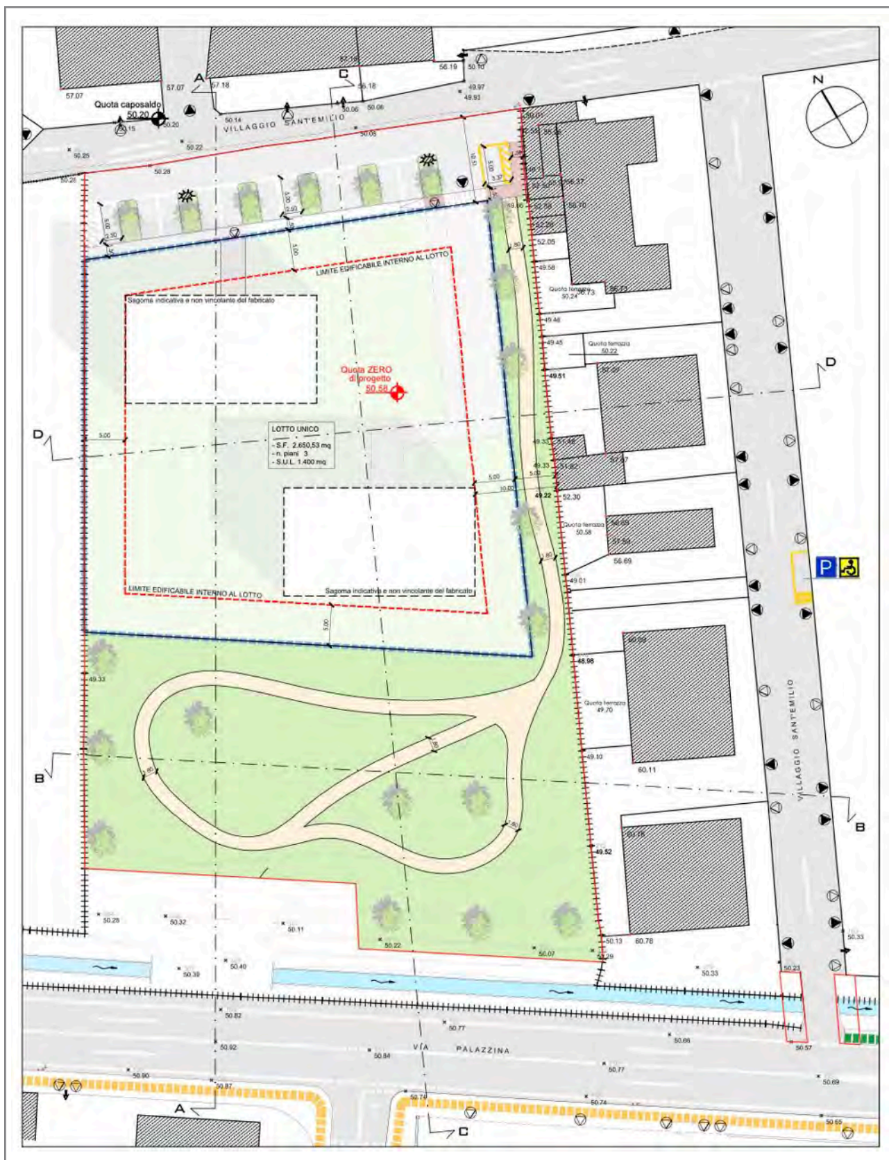
Figura 2. Estratto di progetto del suo PUA “Villaggio Sant’Emilio” con indicato in tratteggio rosso il limite edificabile e in tratteggio blu il limite massimo dell’interato.
