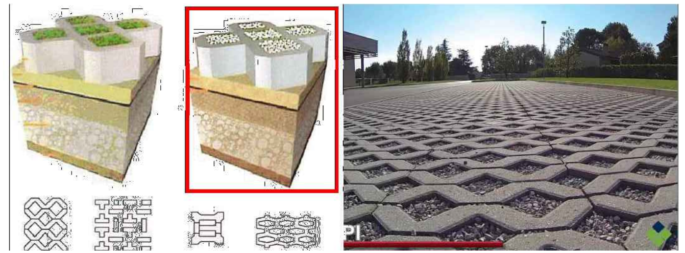
Particolare pavimentazione drenante
