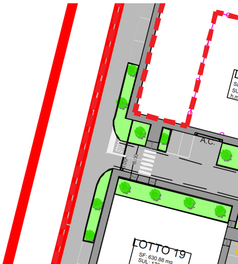
Figura 3 – planimetria di progetto – dettaglio nuova intersezione di accesso ai lotti residenziali
