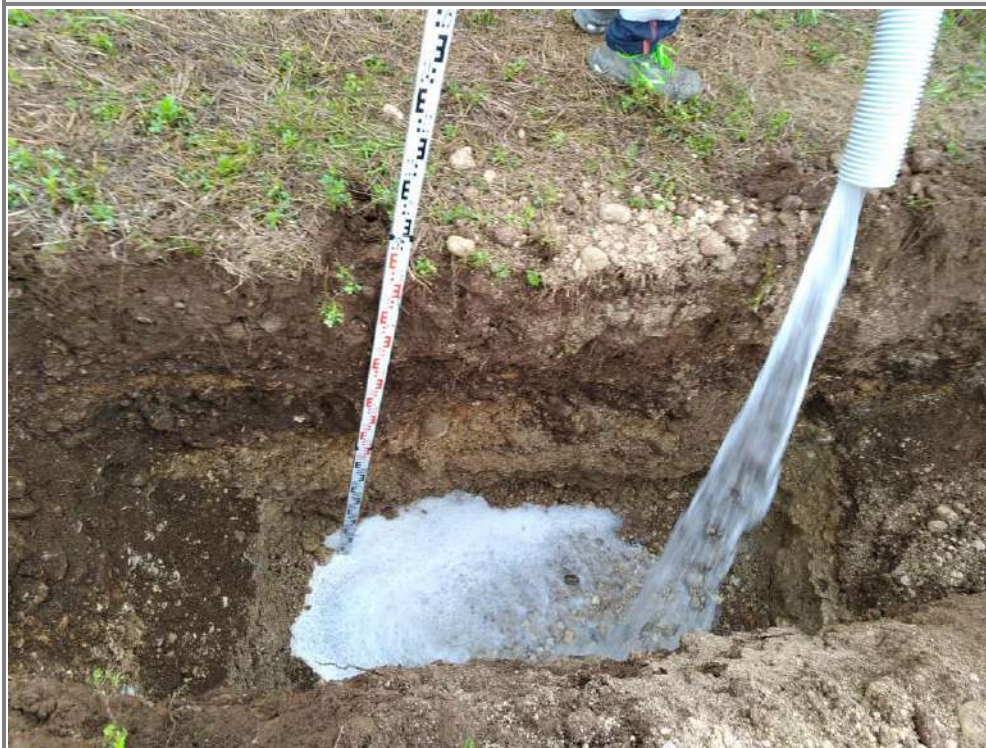
FASE DI RIEMPIMENTO DEL POZZETTO DI PROVA
