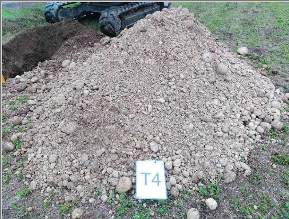
MATERIALE RIFERIBILE ALL'UNITÀ "Gs": ghiaia in matrice sabbiosa
