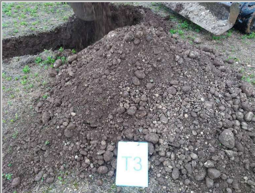
MATERIALE RIFERIBILE ALL'UNITÀ "GL": ghiaia in matrice limosa
