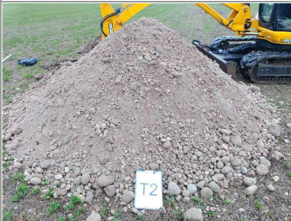
MATERIALE RIFERIBILE ALL'UNITÀ "GS": ghiaia in matrice sabbiosa
