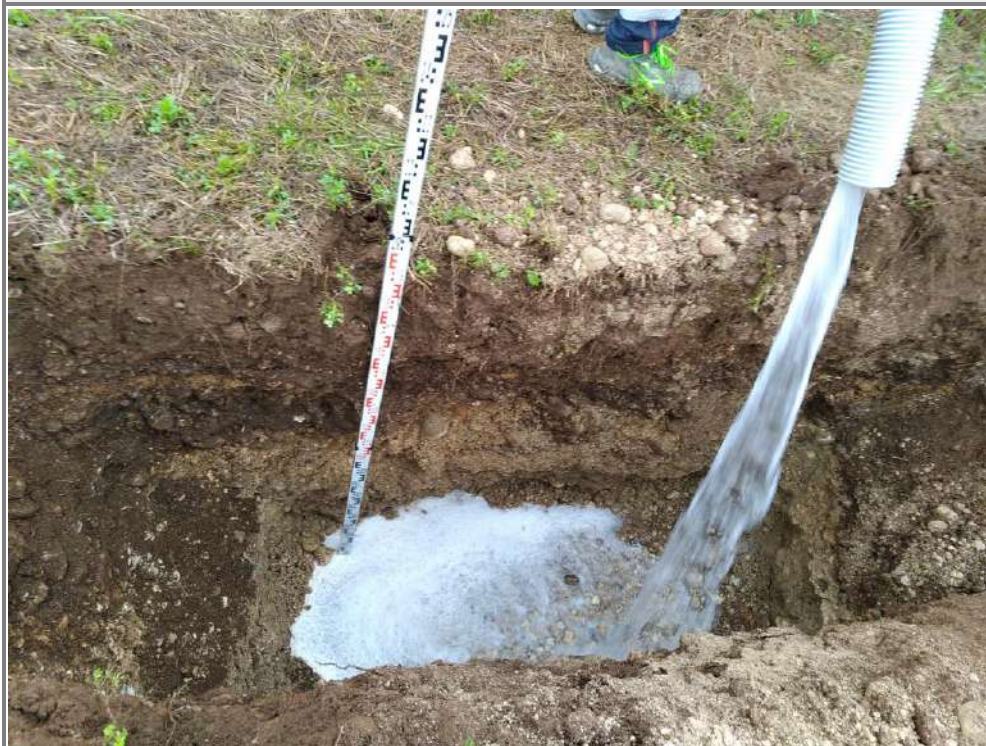
FASE DI RIEMPIMENTO DEL POZZETTO DI PROVA
