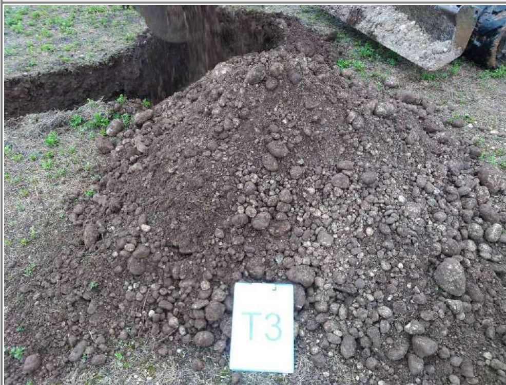
MATERIALE RIFERIBILE ALL'UNITÀ "GL": ghiaia in matrice limosa
