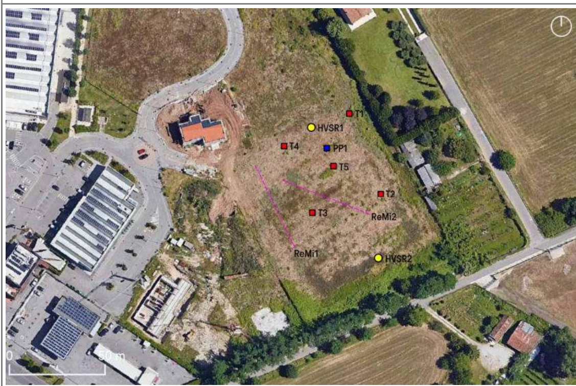
Fig. 26. Ubicazione delle indagini condotte in corrispondenza dell'area d'intervento: trincee esplorative ( in rosso ), stendimenti sismici passivi Re.Mi. ( in magenta ), misurazione del rumore sismico ambientale a stazione singola con tecnica HVS ( in giallo ) e prova di permeabilità in pozzetto ( in azzurro ).
