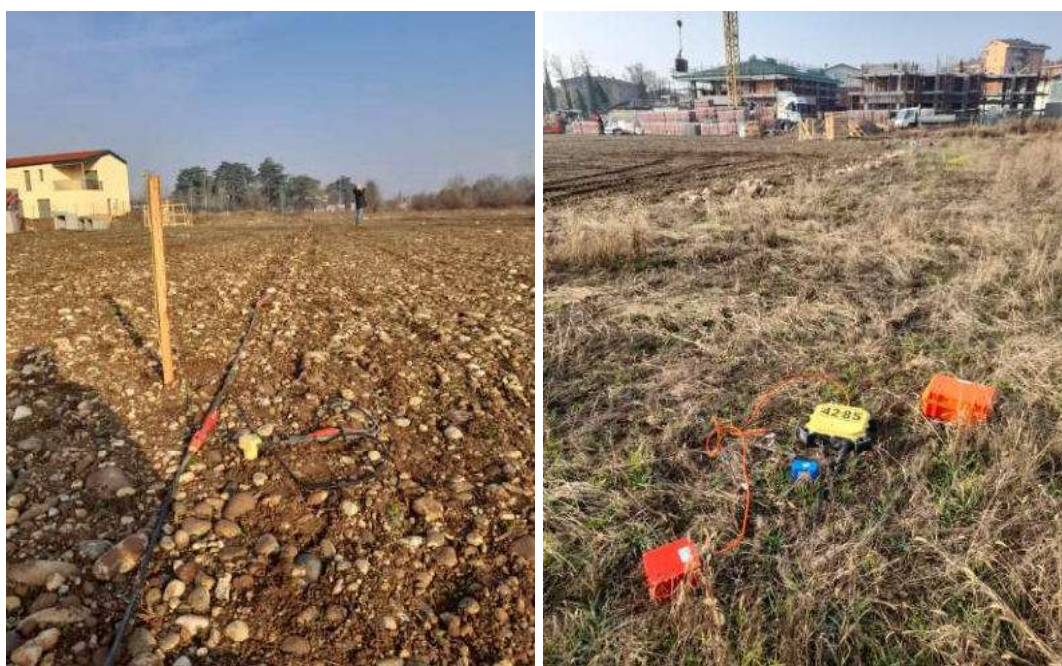
Immagine dello stendimento sismico ReMi e HVSR 1
