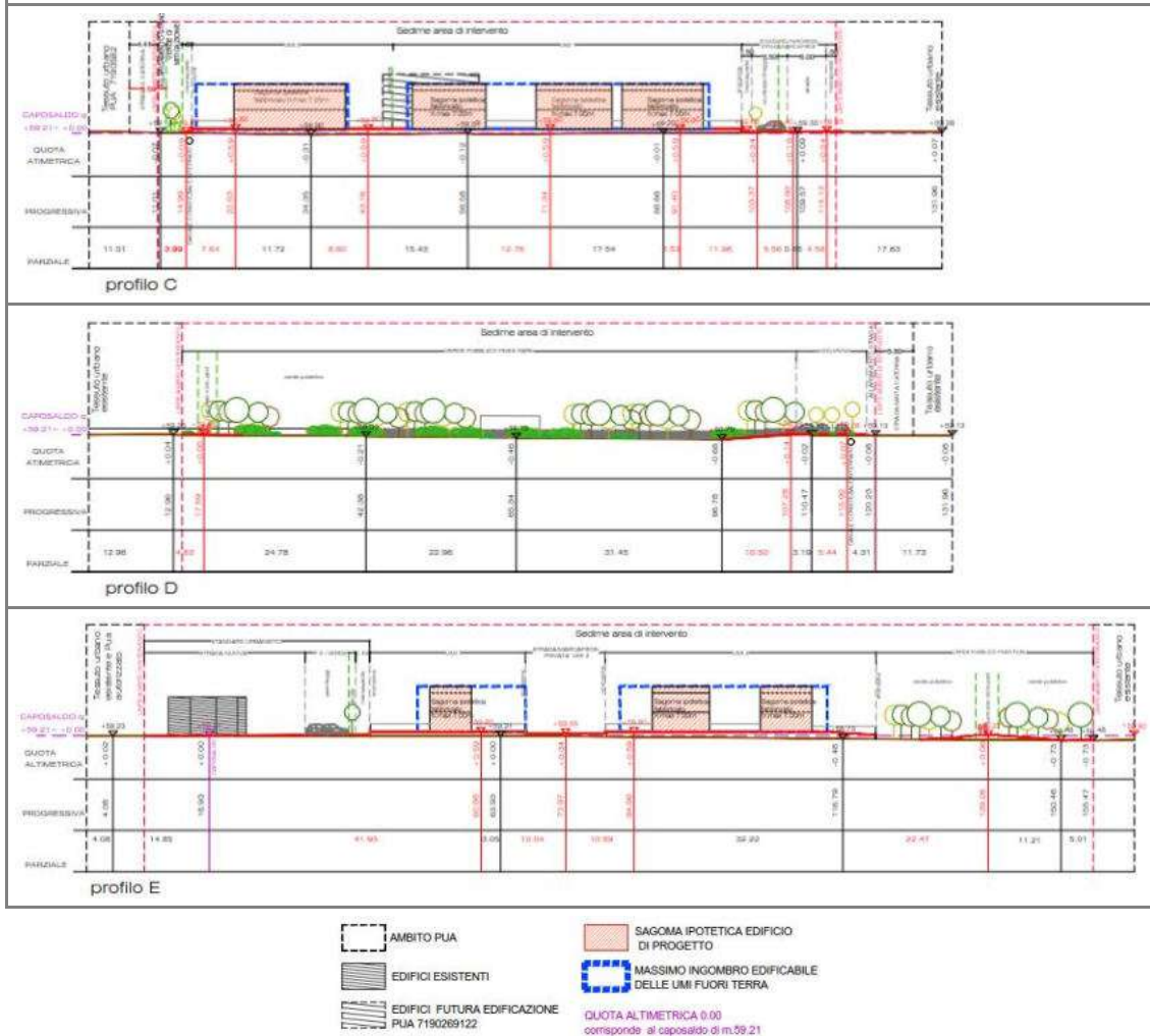
Fig. 3. Estratto fuori scala dalla “Tavola 7.3.1 - Sezioni”: profili C (sotto), D (in mezzo) ed E (in basso).
