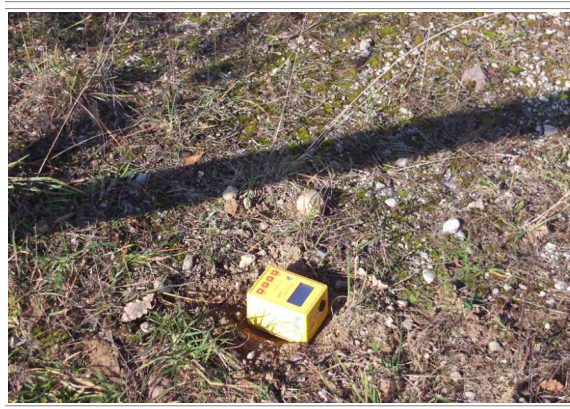
FIG. 10: INDAGINE SISMICA PASSIVA CON TROMINO
