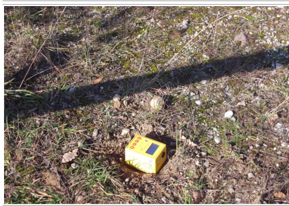
FIG. 10: INDAGINE SISMICA PASSIVA CON TROMINO
