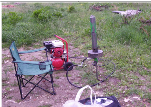
FIG. 9: PROVA PENETROMETRICA DINAMICA DPM
