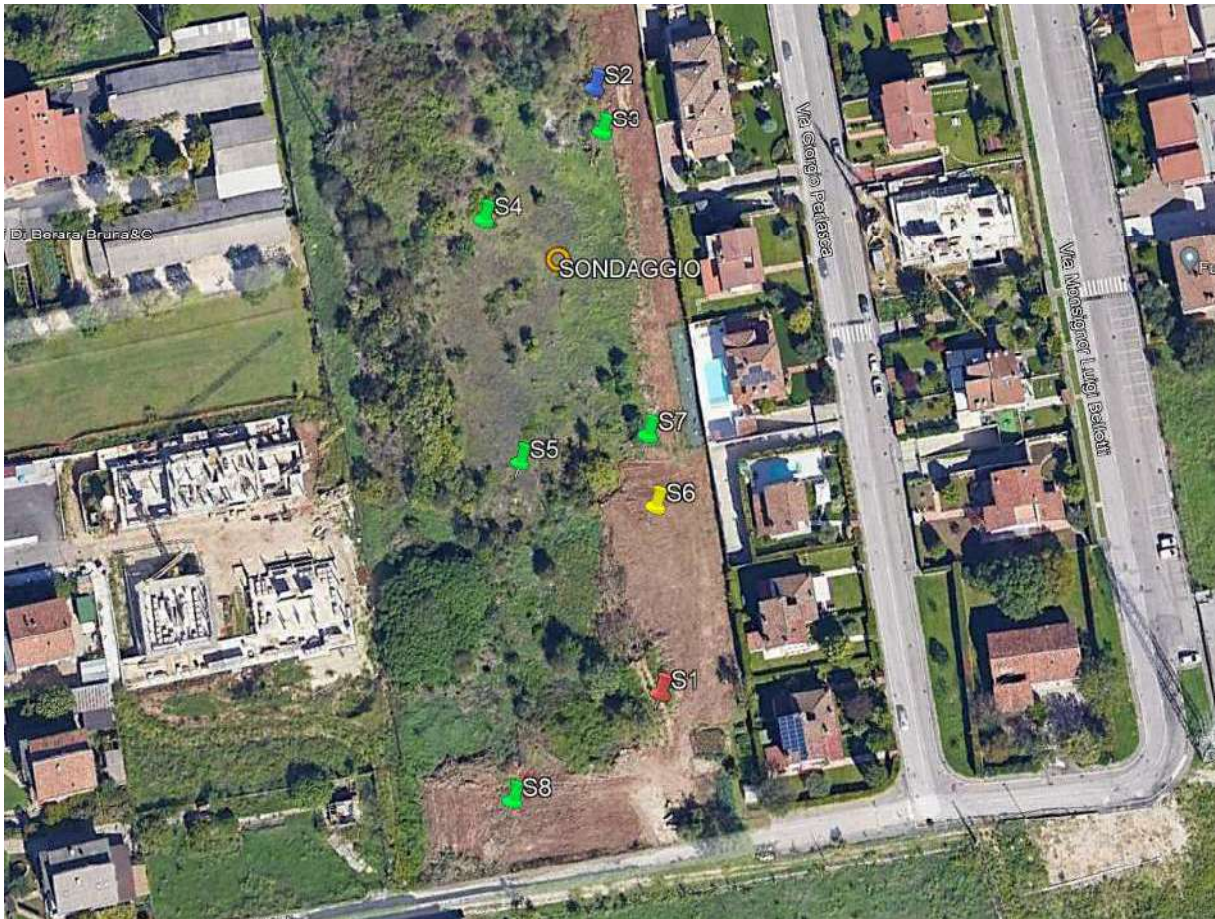
Fig. 9 – posizione delle indagini. In verde i saggi che hanno indagato ghiaia, in blu il saggio S2 (bloccato da soletta in cemento), in giallo il saggio S6, che ha individuato il punto di transizione tra riporto e ghiaia, in rosso il saggio S1 che ha indagato solo riporto. Il sondaggio ha individuato ghiaia.
