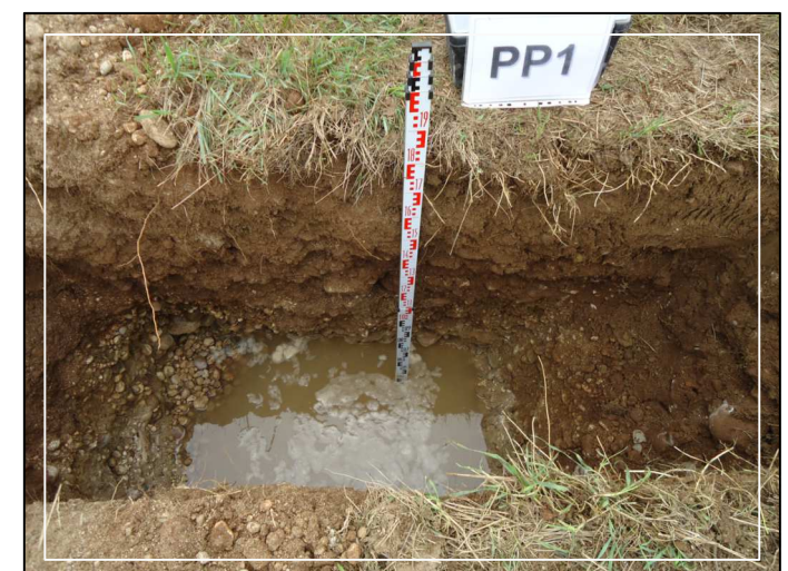
Immagine del pozzetto nel corso della prova di permeabilità.
