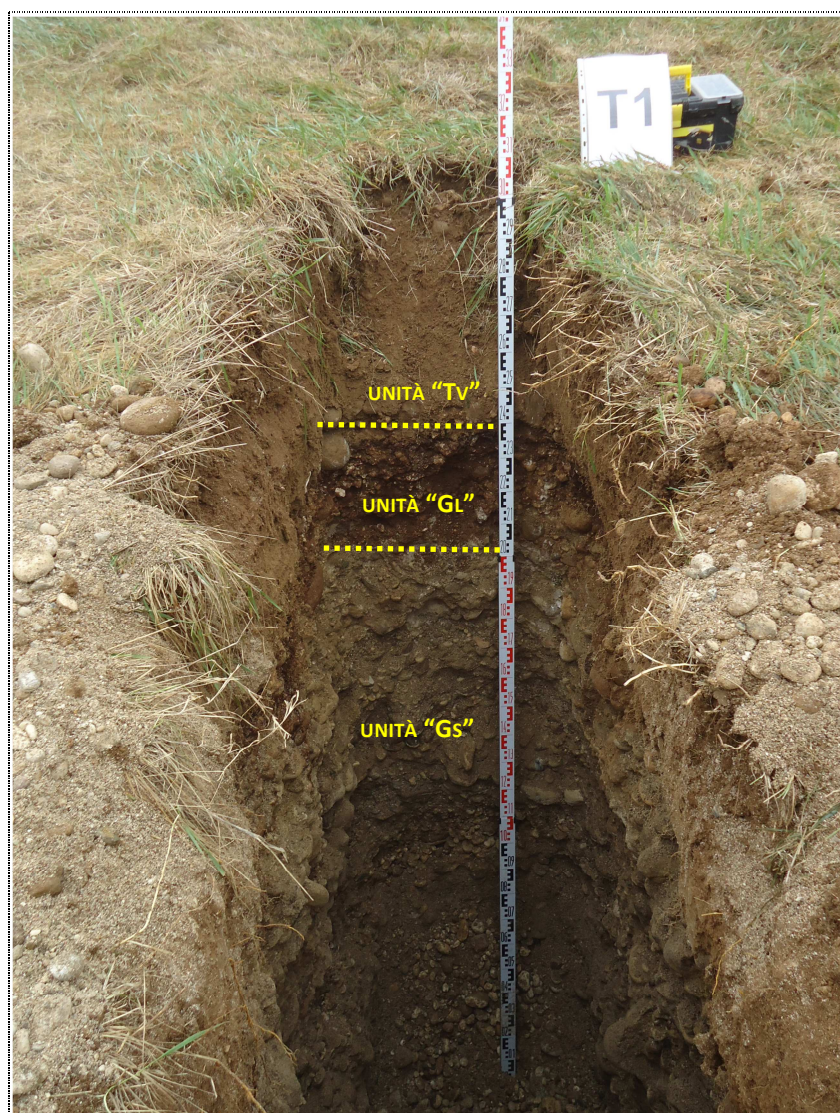
Fig. 6. Modello stratigrafico "tipo" evidenziato sul fronte di una delle trincee eseguite.
