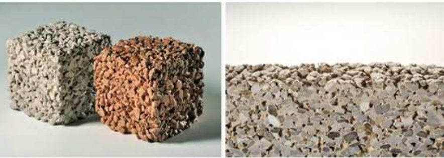
IMMAGINE TIPO PAVIMENTAZIONE DRENANTE
