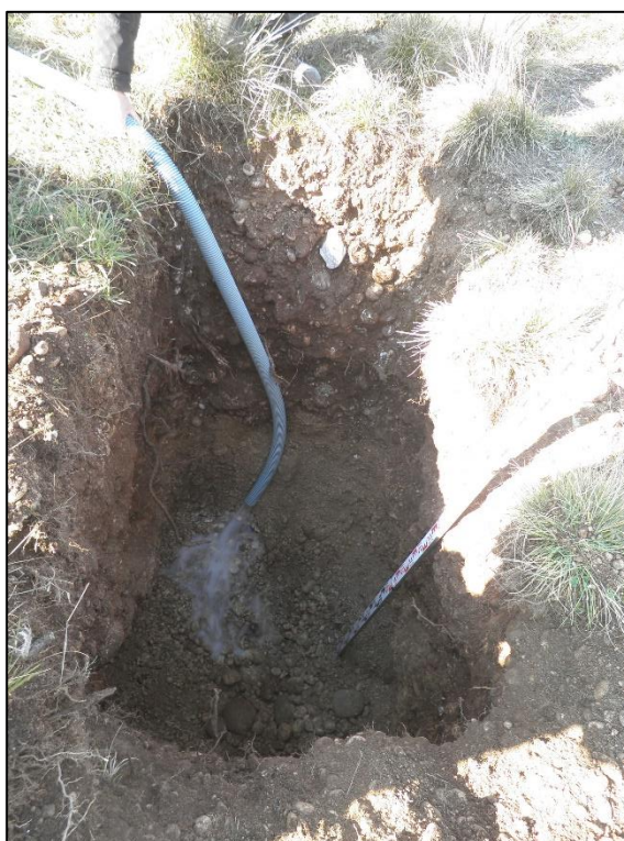
Fasi esecutive della prova di permeabilità P1: i livelli idrici all'interno del pozzetto di prova, delle dimensioni di 2,2 x 1,6 x 1,0 m, hanno raggiunto un'altezza massima di 5 cm.
