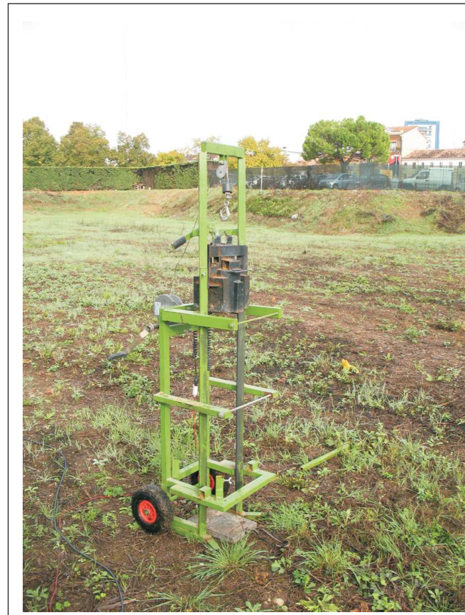
Struttura di supporto della massa battente da 60 kg per l'energizzazione del sottosuolo
