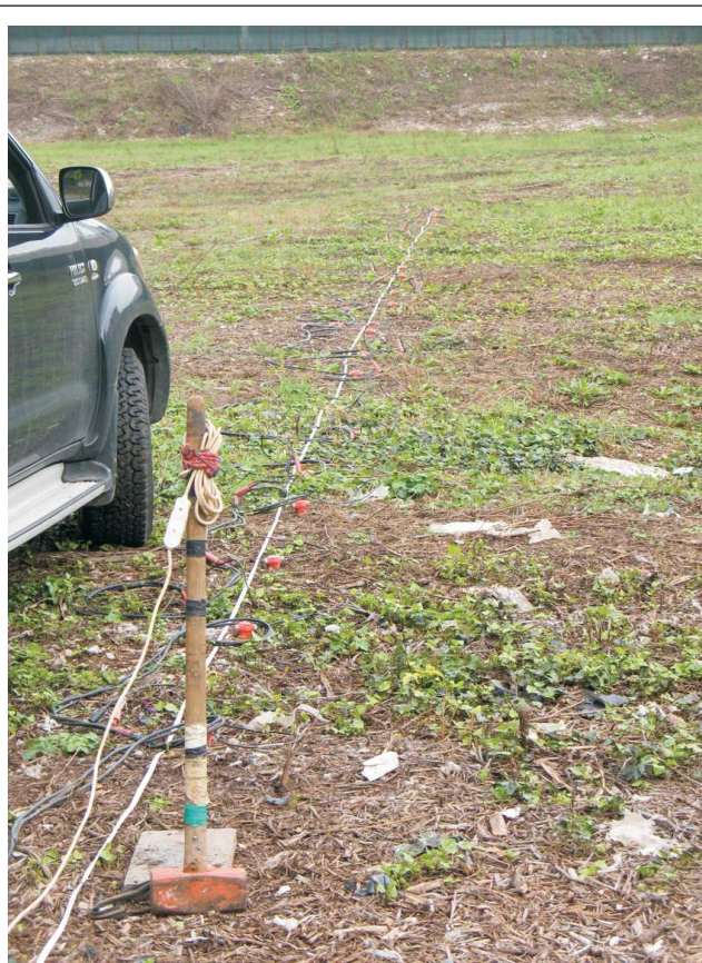
Allineamento dello stendimento MASW n.1; vista in direzione nord
