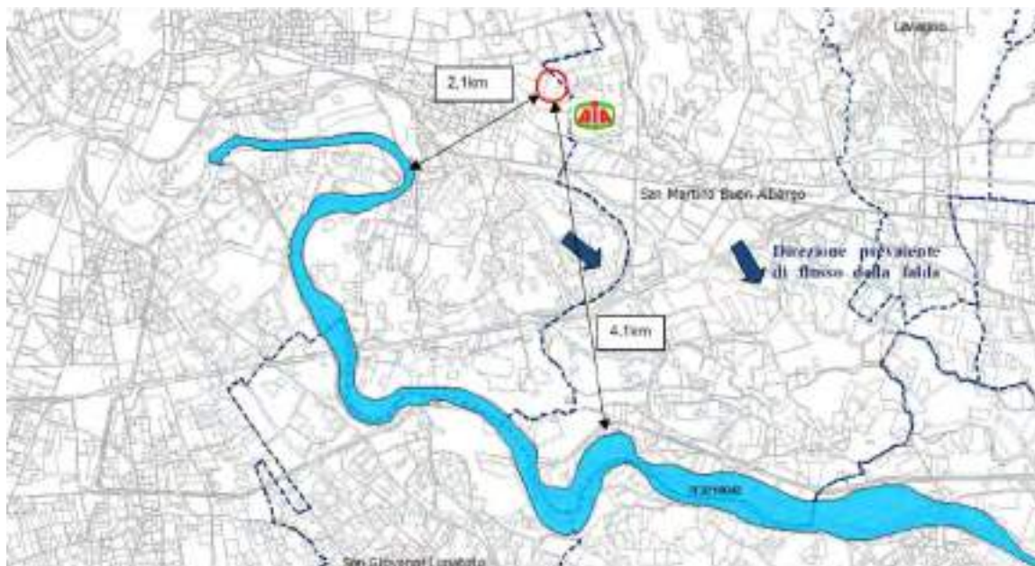
Carta delle falde dell'area di progetto dell'area SIC IT 3210042 con indicazione della direzione prevalente di flusso della falda idrica
