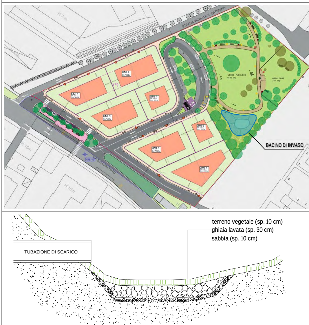
Fig. 16. Sotto : planimetria di progetto con possibile ubicazione indicativa del bacino di invaso (in blu) all'interno dell'ambito d'intervento. In basso : sezione tipo di sbocco nel bacino delle tubazioni di scarico.
