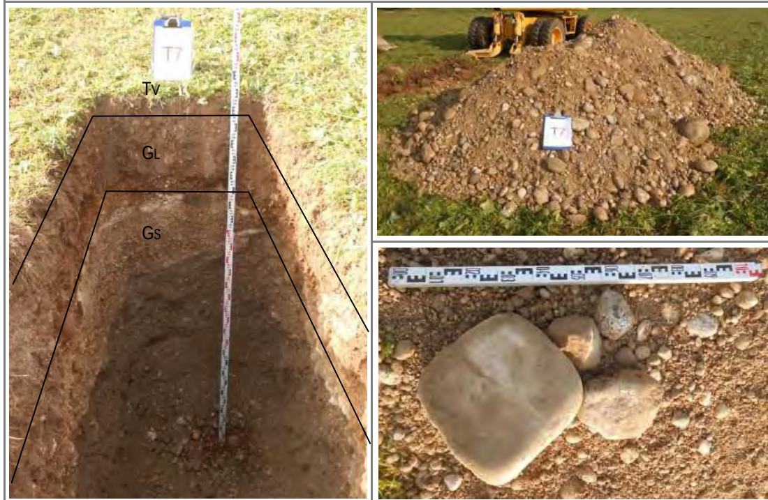
Fig. 6. Particolari della parete di scavo di una delle trincee esplorative eseguite all'interno del lotto oggetto di studio ( sotto a sx ), del materiale riferibile all'unità "Gs" ( sotto a dx ) e di ciottoli e trovanti rinvenuti ( in basso a dx ).
