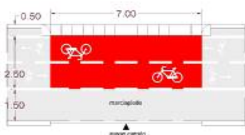
CONTINUITÀ DEL MARCIAPIEDE E DELLA PISTA CICLOPEDONALE PRESSO LO SBOCCO DI UN PASSO CARRAIO.
