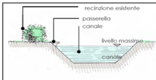
sezione tipo A (dove il canale e la nuova passerella confinano con un muro o una recinzione)
