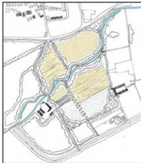
C1 interventi di riqualificazione fluviale estesi alle aree circostanti con formazione di vasche di laminazione
