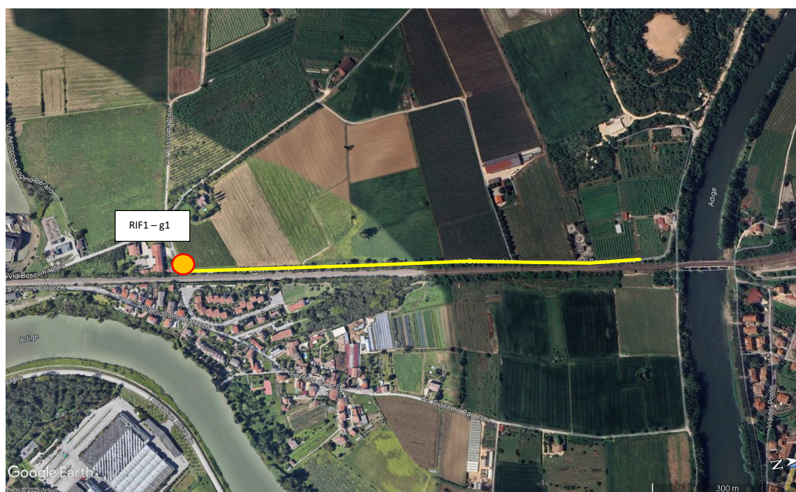
Ubicazione prove in sito e posizione del geofono g1 - inizio linea
